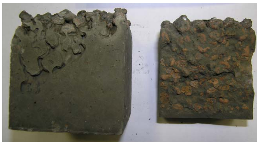
Рисунок 4.4 – Оценка равномерности распределения легкого заполнителя по объему бетона: заполнитель всплывает на поверхности, дефекты ребер и граней, расслоение бетонной смеси
