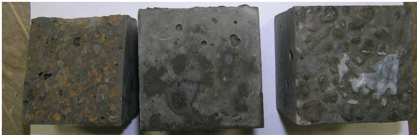
Рисунок 4.2 – Оценка равномерности распределения легкого заполнителя по объему бетона: расслоения нет, заполнитель не всплывает, поверхность хорошая
