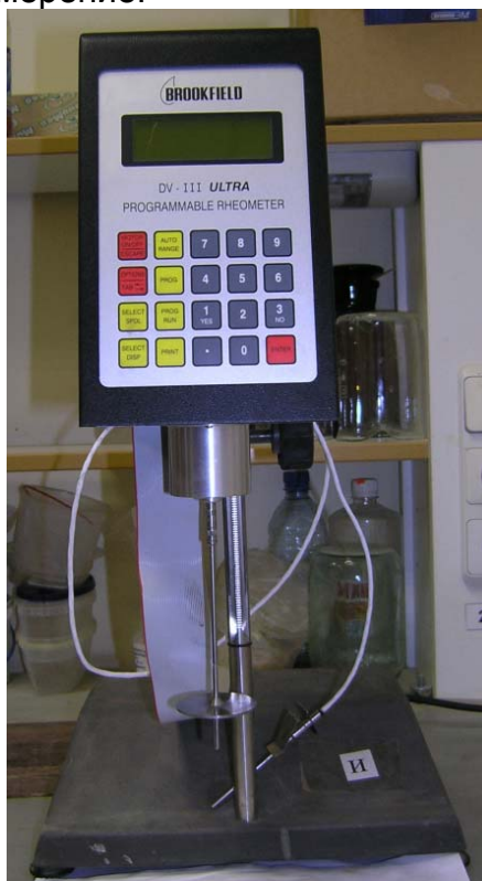
Рисунок 4.5 - Программируемый реометр DV-III Ultra компании Brookfield, США Определение напряжения сдвига осуществляется в следующей последовательности:
