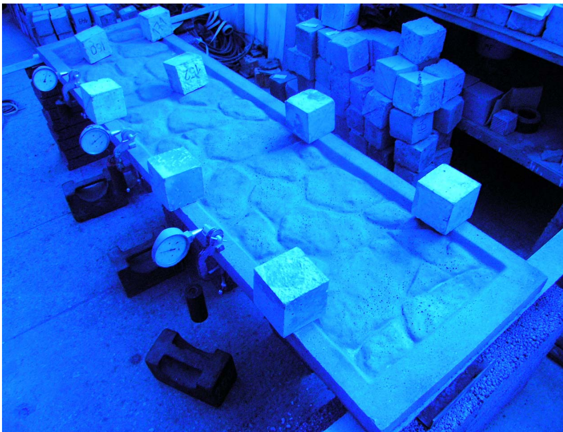
Рисунок 18. Испытание панелей оград из сталефибробетона
