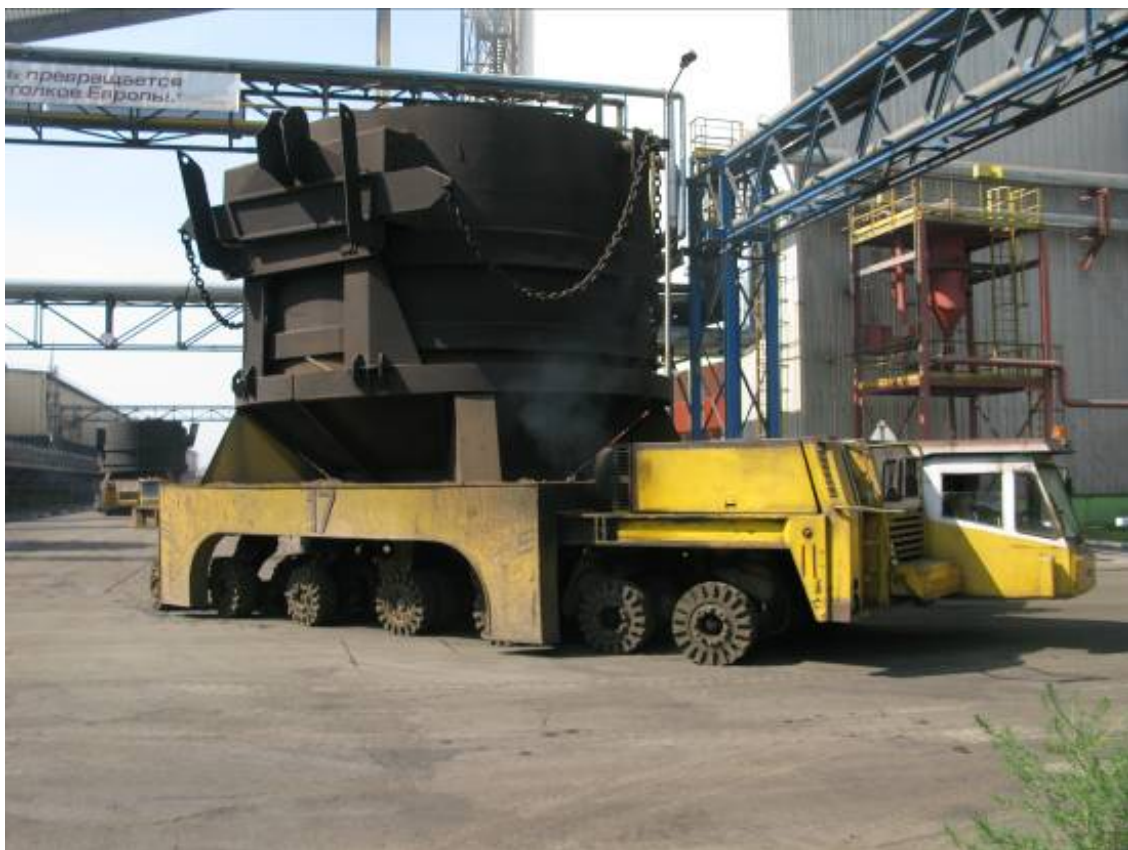
Рисунок 17. Общий вид технологического транспорта РУП БМЗ с нагрузкой на ось до 150 кН и монолитных плит технологических дорог, г. Жлобин
