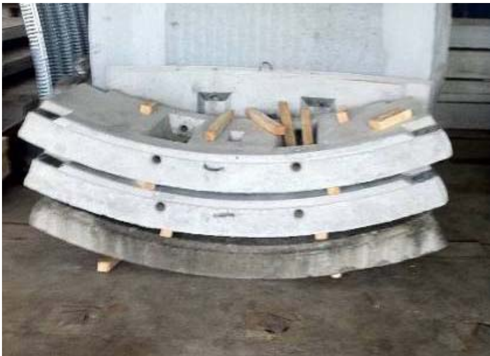
Рисунок 21. Изготовленные экспериментальные тьюбинги. Внизу типовой тьюбинг марки 55Р, далее вверх тьюбинги 55Р.Н.СФ-1, 55Р.Н.СФ-2.
