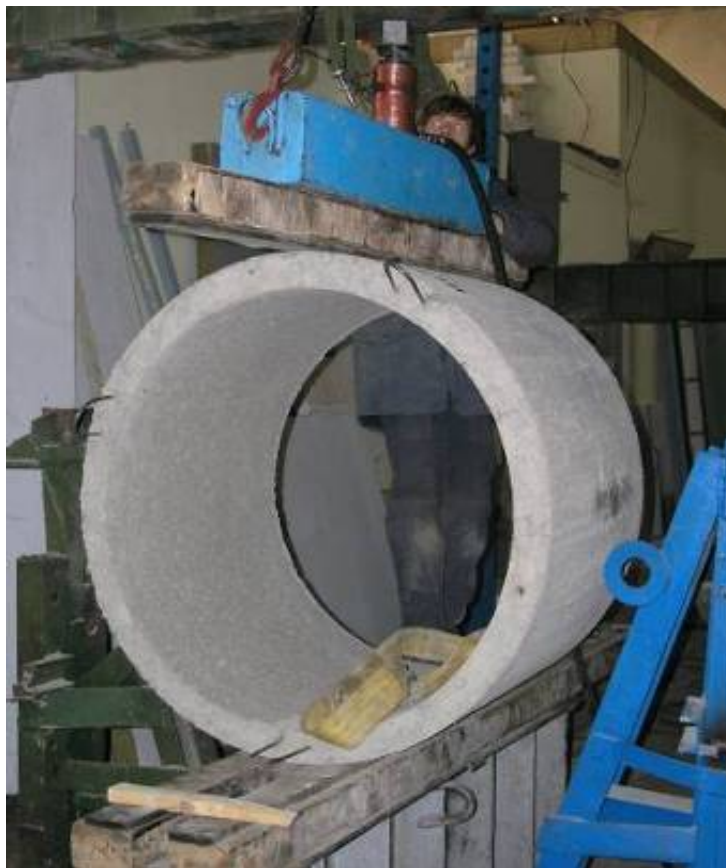
Рисунок 19. Подготовка к испытаниям сталефибробетонного кольца КС10-9 по «повернутой схеме»
