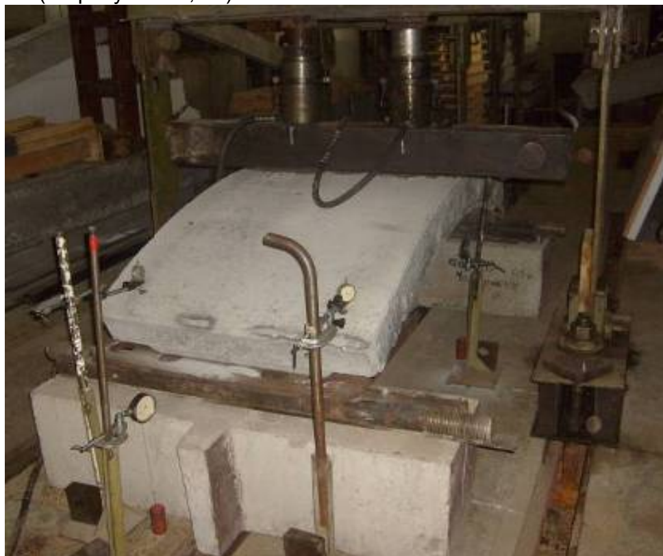
Рисунок 20. Испытания экспериментальных конструкций тунбингов 55Р.Н.
