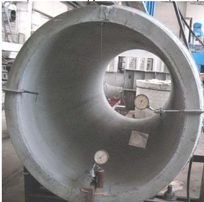
Рисунок 4. Испытание трубы марки ТБ100.25-5 нагружением
