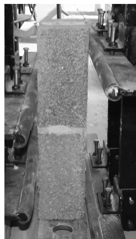
Рисунок 2. Испытание образца на растяжение при изгибе по перевязанному сечению: а – схема испытания; б – опытный образец в испытательной установке
