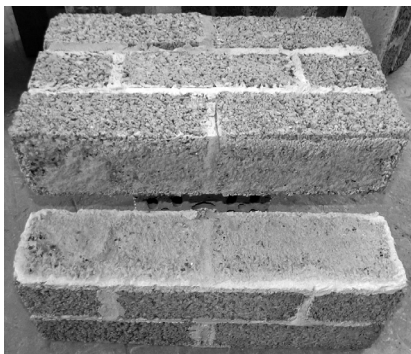
Рисунок 3. Характер разрушения образцов: а – на границе между строительным раствором и кладочным элементом и при растяжении в пределах кладочного элемента вблизи границы; б – на границе между строительным раствором и кладочным элементом и при растяжении в пределах слоя раствора; в – на границе между строительным раствором и кладочным элементом
