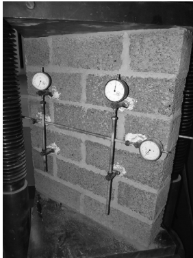
Рисунок 1. Схема испытаний опытных образцов при сжатии поперек горизонтальных растворных швов: а – общий вид; б – схема расстановки приборов (1 – опытный образец; 2 – индикаторы перемещений часового типа ИГП-1 с ценой деления 0,001 мм; h_s = 580 мм; l_s = 510 мм; t_s = 120 мм)
