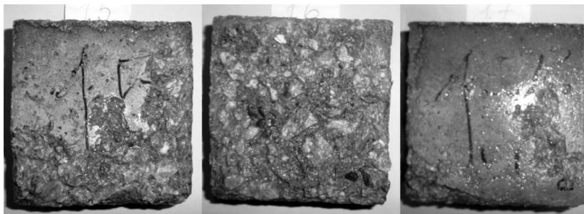
**Рисунок 6.** Образцы с CEM I 42,5 N после 56 циклов замораживания и оттаивания в воде Балтийского моря
