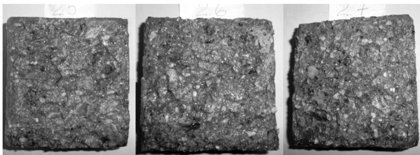
**Рисунок 7.** Образцы с СЕМ II A / S 42,5 N после 56 циклов замораживания и оттаивания в воде Балтийского моря
