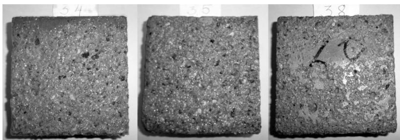
**Рисунок 8.** Образцы с СЕМ III / В 32,5 N после 56 циклов замораживания и оттаивания в воде Балтийского моря
