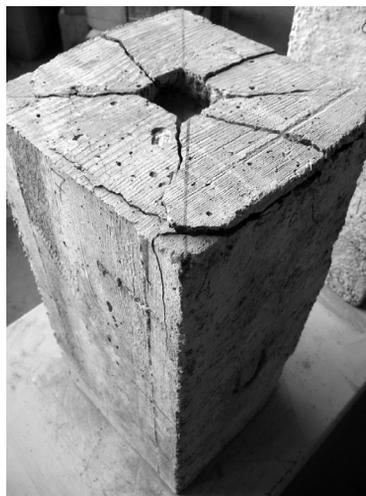
**Рисунок 2.** Характер разрушения образца при передаче нагрузки через штампы сечением 60 x 60 мм
