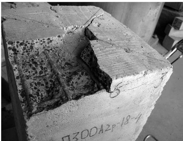
**Рисунок 3.** Отслаивание бетона на верхней грани образца в результате выпучивания стержней сетки при передаче нагрузки через металлический штамп сечением 60 x 60 мм
