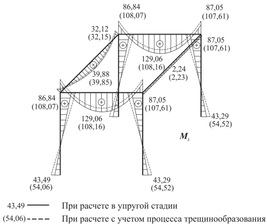
Рисунок 5. Эпюра изгибающих моментов M_z (кНм)
