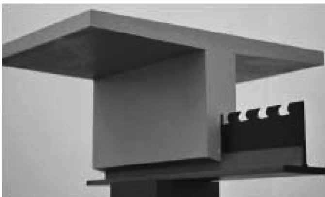
Рисунок 4. Сталежелезобетонное сечение с соединением «на зубцах»
