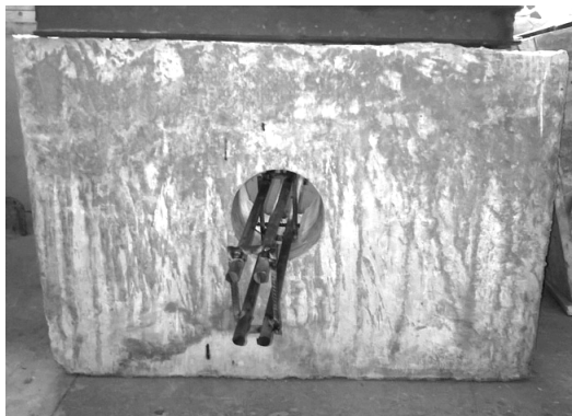
Рисунок 3. Фундаментный блок с армированием стержневым каркасом
