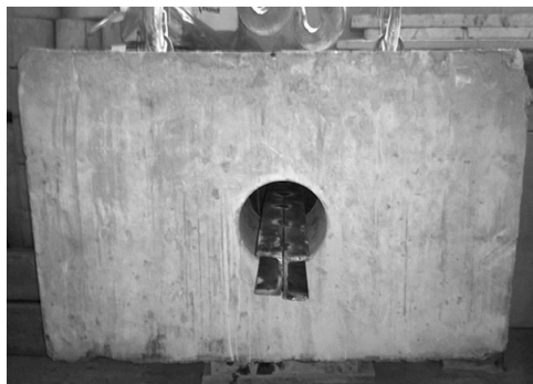
Рисунок 2. Фундаментный блок с армированием двумя швеллерами № 6,5 сваренными стенками
