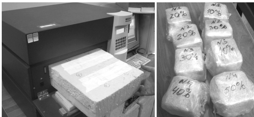
Рисунок 5. Общий вид образцов и экспериментальной установки для определения коэффициентов термовлагопроводности
