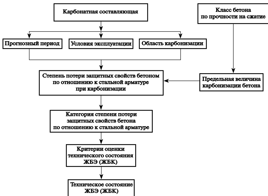
Рисунок 4. Структурная схема блока прогнозирования технического состояния эксплуатируемого ЖБЭ (ЖБК)
