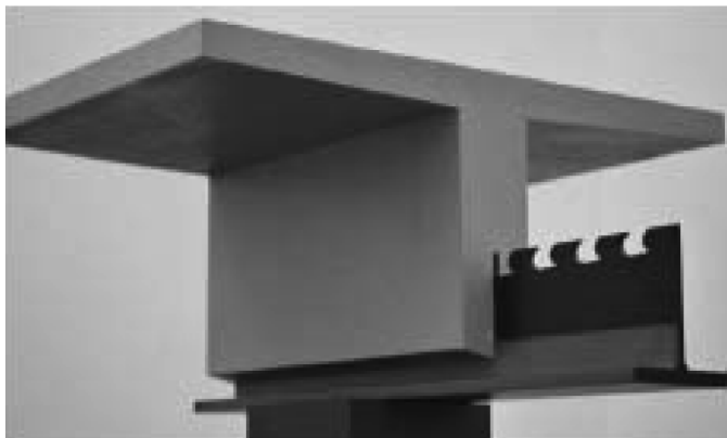
Рисунок 4. Сталежелезобетонное сечение с соединением «на зубцах»
