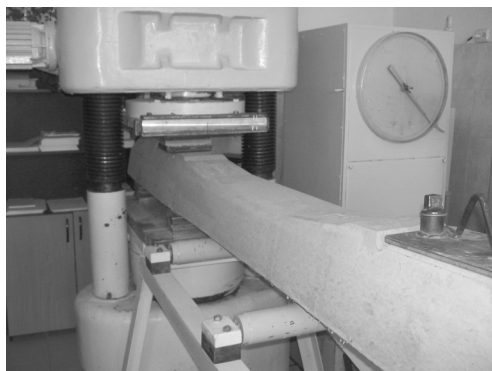
Рисунок 2. Внешний вид испытаний подрельсовой площадки
