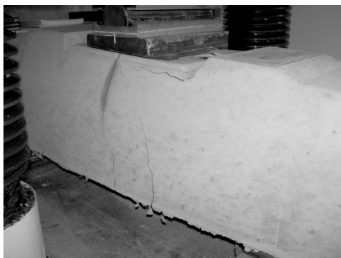
Рисунок 5. Разрушение подрельсовой площадки шпалы
