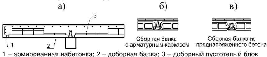
**Рисунок 8.** Конструктивное решение консольного вылета перекрытия с доборными балками, используемыми в качестве несъемной опалубки
