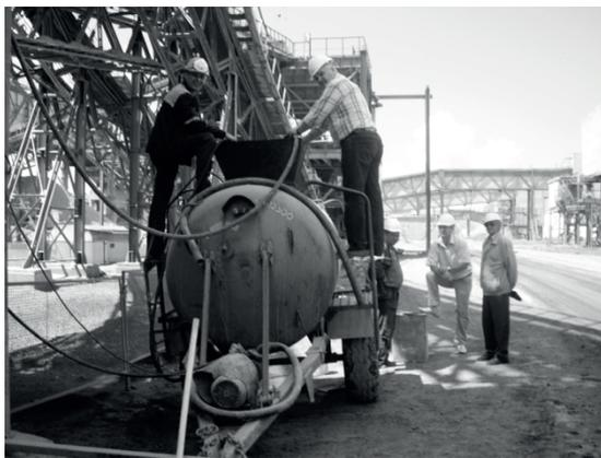
**Рисунок 2.** Передвижная установка подачи активатора
