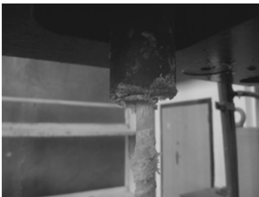
**Рисунок 6.** Характерное отслоение оплеточной нити от тела стержня
