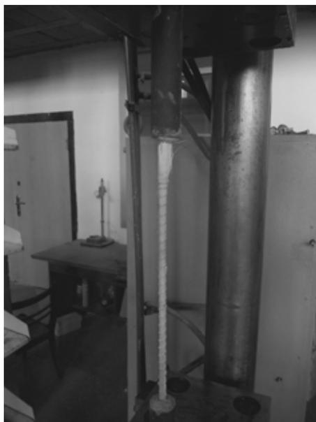
**Рисунок 5.** Общий вид стержня после испытания
