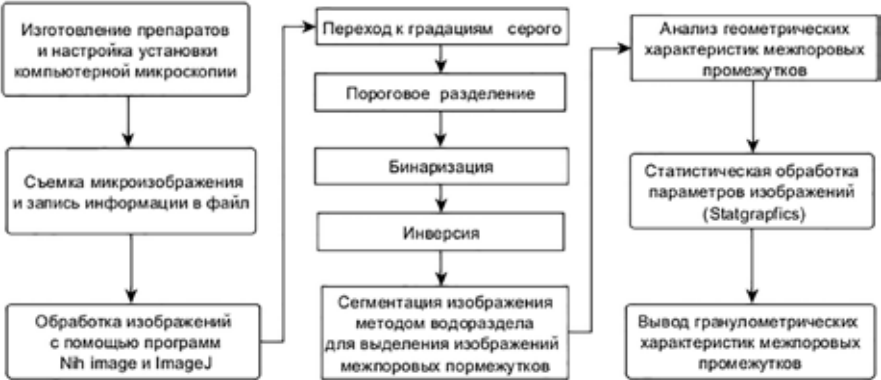
Рисунок 1. Алгоритм компьютерно-микроскопического исследования пористой структуры материала
