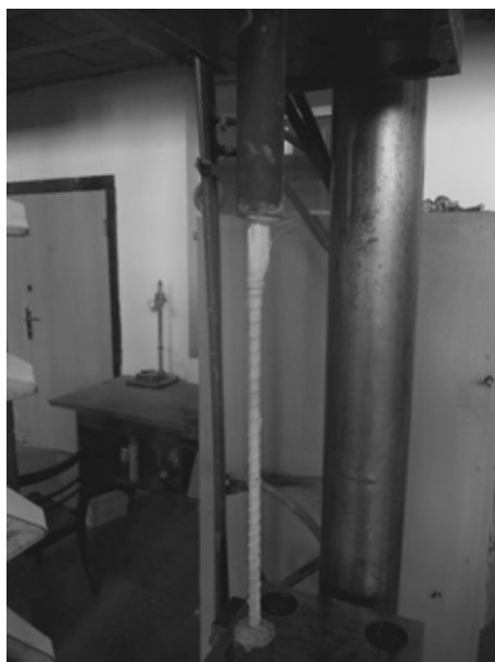
Рисунок 5. Общий вид стержня после испытания
