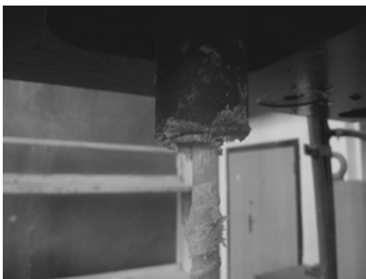
Рисунок 6. Характерное отслоение оплеточной нити от тела стержня
