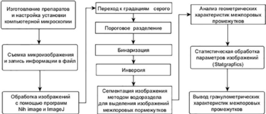
Рисунок 1. Алгоритм компьютерно-микроскопического исследования пористой структуры материала
